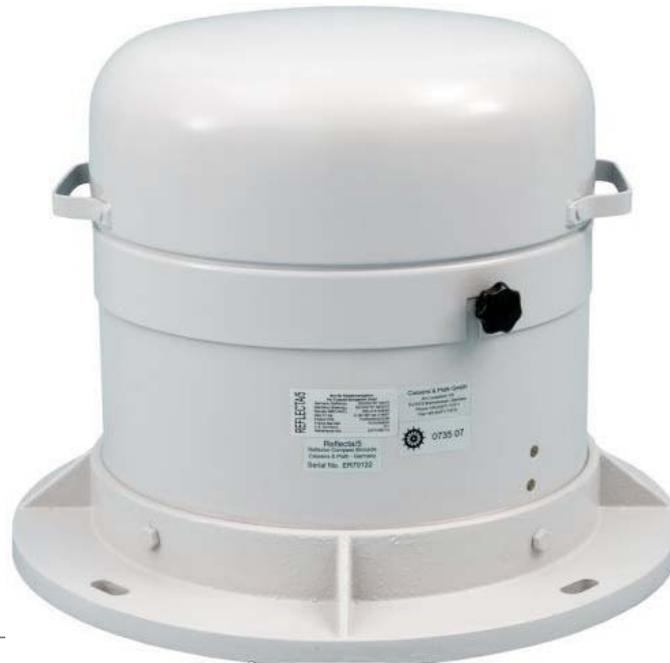
REFLECTA/5 ist ein Reflexions-Kompass-Stand für kleinere Fahrzeuge im küstennahen Bereich. Die Kompass-Säule kann je nach magnetischen Gegebenheiten in unterschiedlichen gestuften Längen geliefert werden. Peilmöglichkeiten sind nicht vorhanden, da der Steuerkompass Type/21 eingesetzt wird. B+C, D und K-Kompensierung müssen separat angebracht werden. Beleuchtung ist enthalten.
